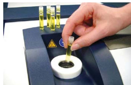
Obr. 5. Měření oleje na analyzátoru MPA
