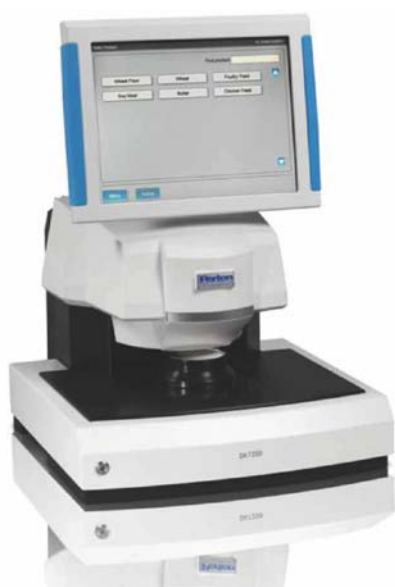
Obr. 1 – NIR analyzátor DA7250, výrobce PERTEN INSTRUMENTS, často používaný v krmivářském průmyslu
